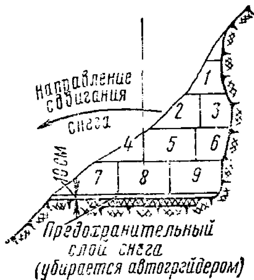
Рис. 17. Очистка дороги в горных условиях со сбрасыванием снега под откос
